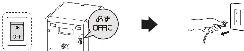
! フィルターのお手入れの際は、必ず温水スイッチを切り電源プラグを抜いてください。
